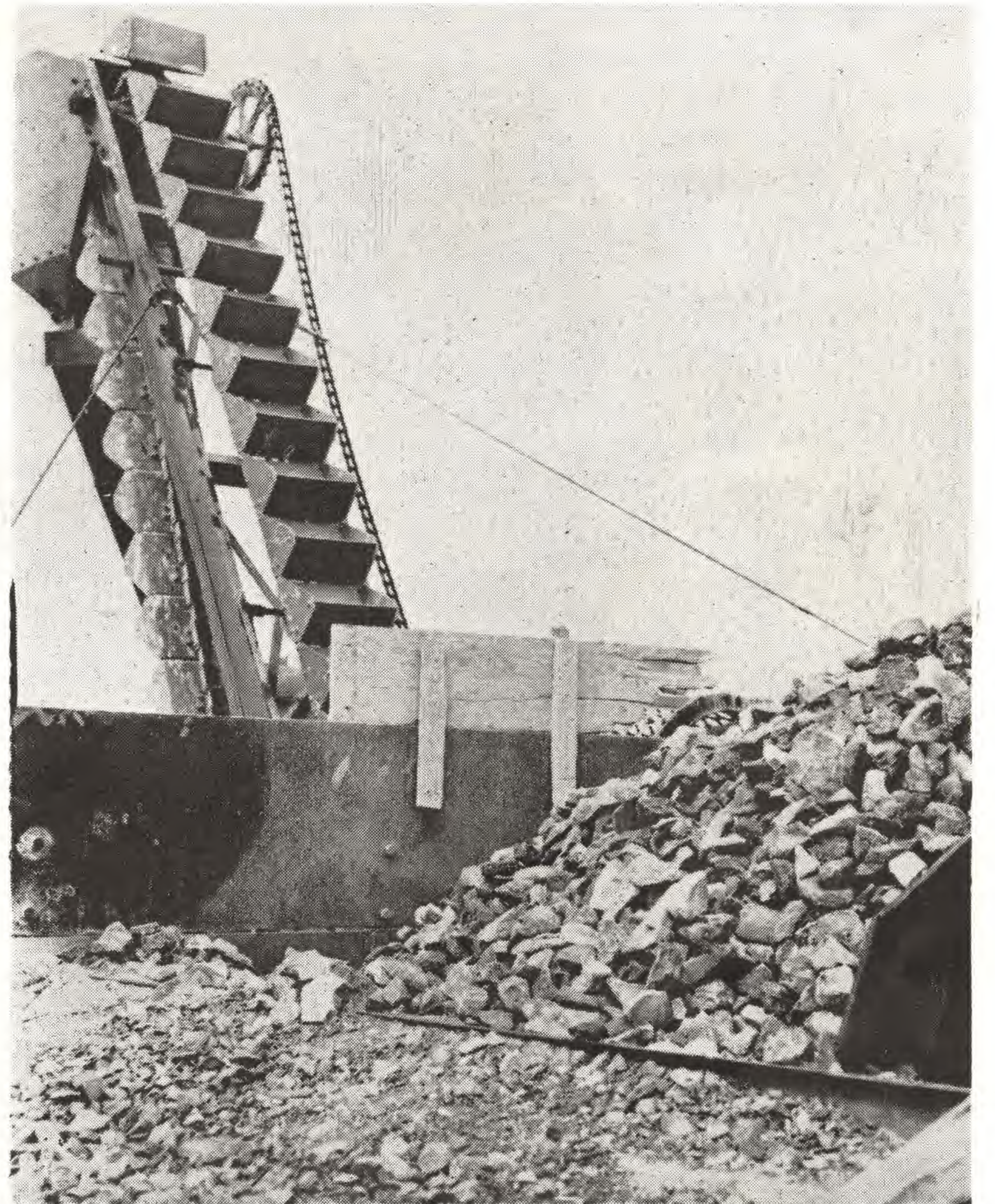
Het product van de kaakbreker dat door de rolbreker tot kleinere afmetingen zal worden verwerkt.
